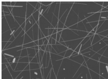
Nanomaterials (60nm diameter Ag wire)
